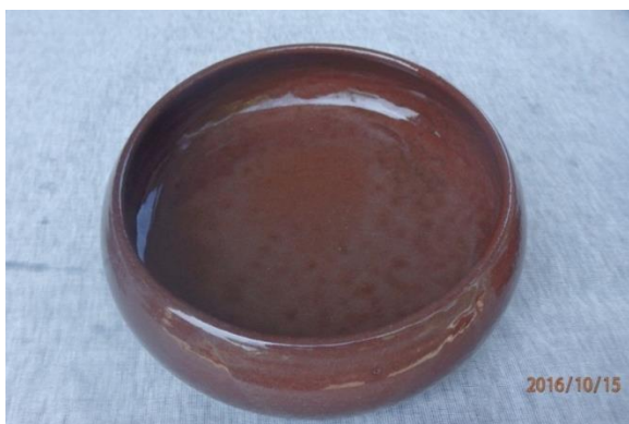
Gambar 5. Hasil Produk Keramik Berupa Mangkok Sayur Berbahan Baku Tanah Liat Campuran antara Lumpur Lapindo Sidoarjo dan Abu Gunung Merapi (Sumber: Dokumentasi Tim Pengabdian, Juni 2016)
